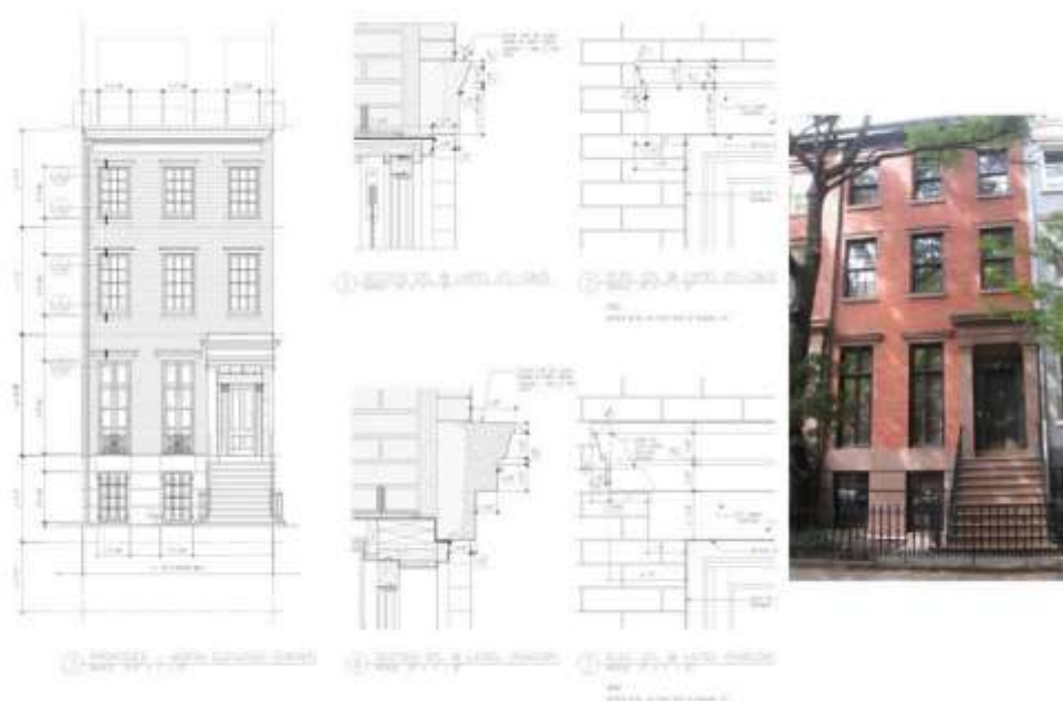
Εικ. 6: απόψη μετά την αποκατάσταση της κύριας όψης, της κλίμακας και του φράχτη και την τοποθέτηση των νέων κουφωμάτων, πλην της θύρας εισόδου και λεπτομέρειες πλαισίων παραθύρων.
