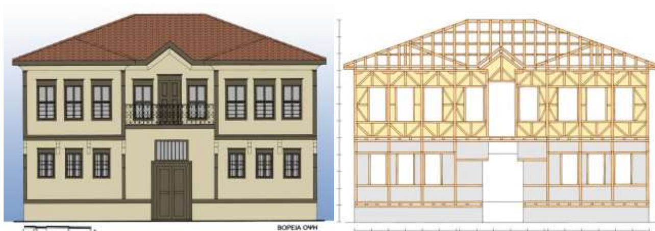
Εικ. 4: Κύρια όψη της κατοικίας Χάρη (1873) και η κατασκευή της
