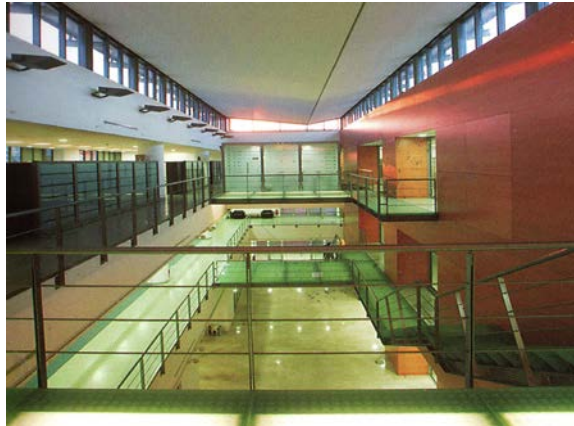
Εικ. 6β: Το παρόν: φεγγίτες ανοιγόμενοι με αυτόματο σύστημα για διαμπερή ή και μονόπλευρο αερισμό σε σύγχρονο κτίριο (κτίριο Διοίκησης της S&B Βιομηχανικά Ορυκτά- αρχ. Α. Τομπάζης)
