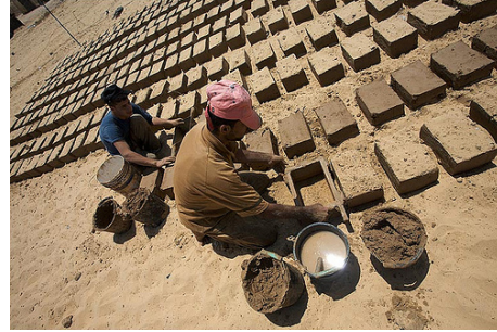
Εικ.1: Χειρονακτικός τρόπος κατασκευής ωμόπλινθων, Πηγή: www.flickr.com
